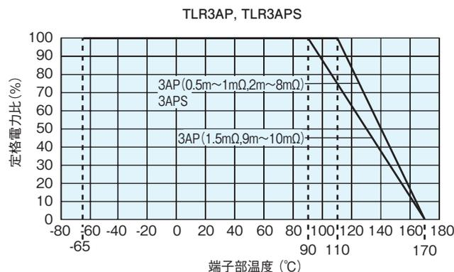
定格端子部温度以上で 사용되는場合は、上図負荷軽減曲線に従って、電力を軽減して御使用ください。
