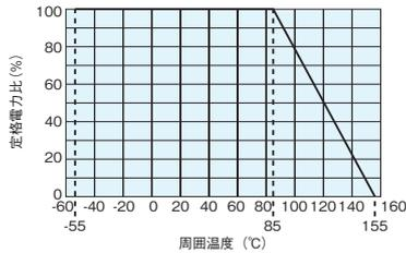
周囲温度85℃以上で使用される場合は、上図負荷軽減曲線に従って、電力を軽減して御使用ください。
