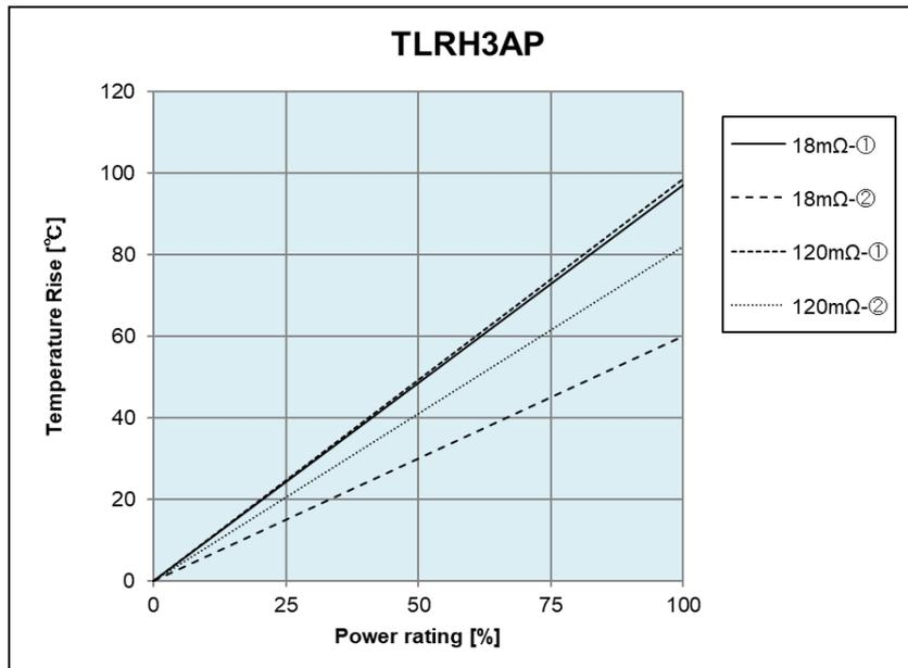
温度上昇については、弊社測定条件下で測定しているため、使用条件、使用基板により数値が異なります。
