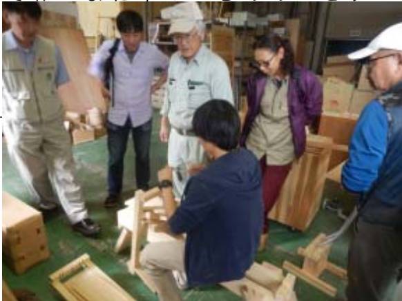
折り畳み式木馬のような小物加工用治具
