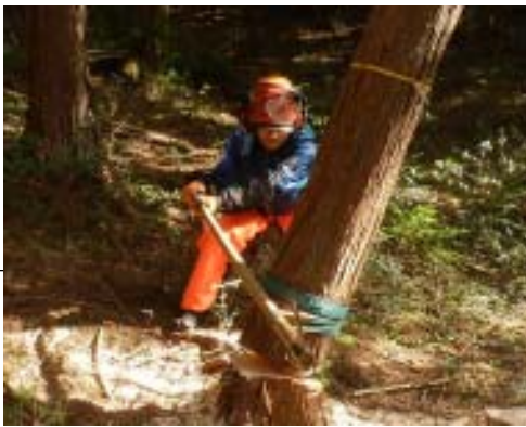
スリングベルトとトビでかかり木の処理
