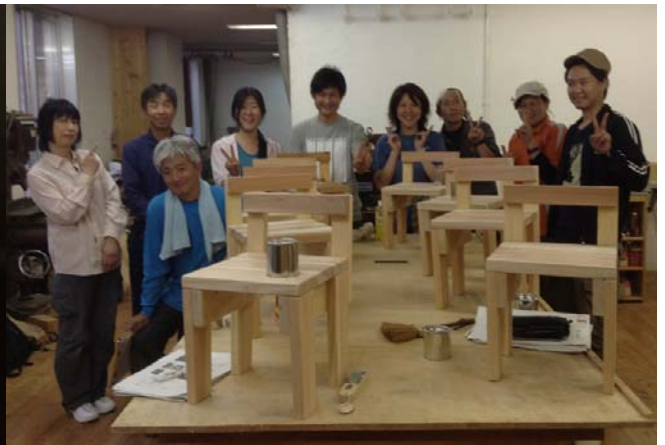
⑤仕上げ 紙やすりで丁寧に仕上げ、その後レモンオイルで塗装を繰り返します。みんなで記念撮影。充実感です。
