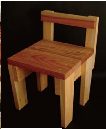
⑤仕上げ 紙やすりで丁寧に仕上げ、その後レモンオイルで塗装を繰り返します。みんなで記念撮影。充実感です。
