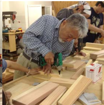
③座面の座彫り インパクトドライバーでさくさく穴を開けていきます。
