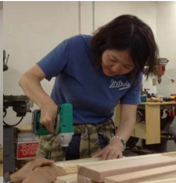
③座面の座彫り インパクトドライバーでさくさく穴を開けていきます。
