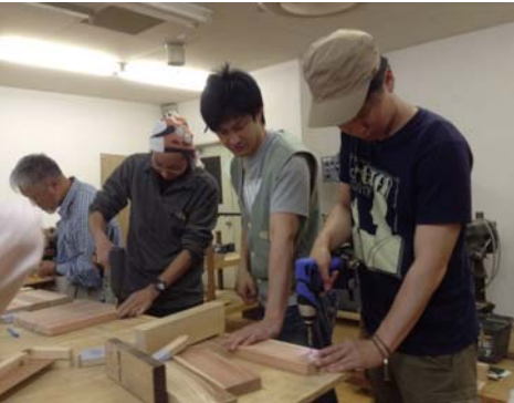
③座面の座彫り インパクトドライバーでさくさく穴を開けていきます。
