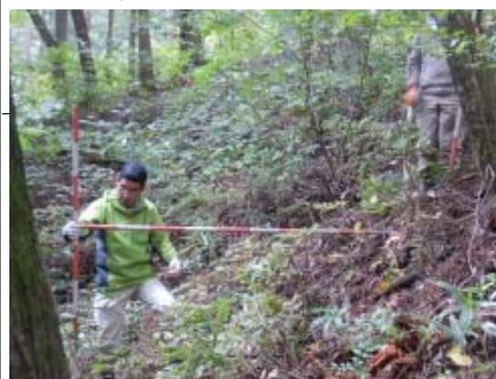
ポールを使って横断の傾斜を採る。水平OK?
