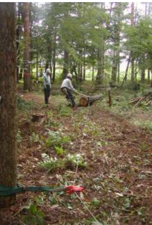
滑車を使って方向を変え、二段集材
