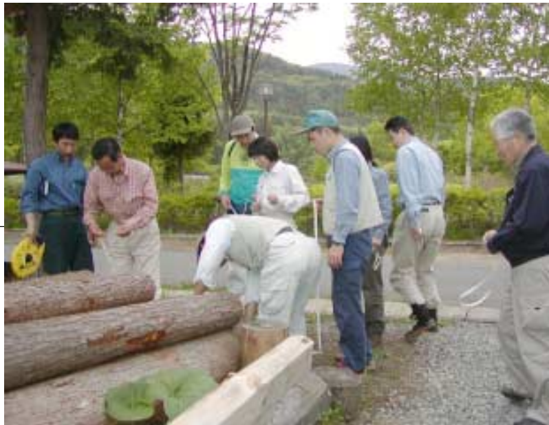
丸太の直径は、樹皮を除いて測ります
