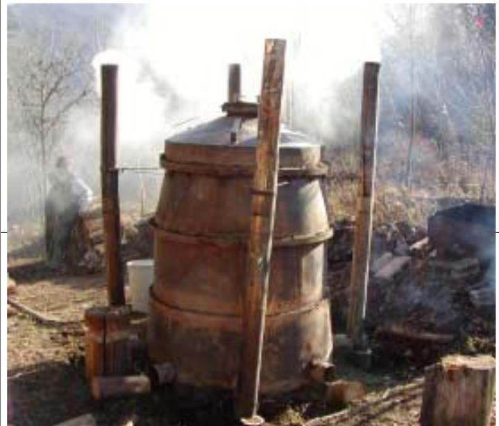
林試式といわれる移動式炭化炉 1200 型
