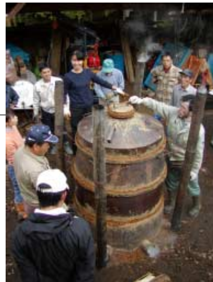
下段まで熱が回り先端の煙道を閉じる
