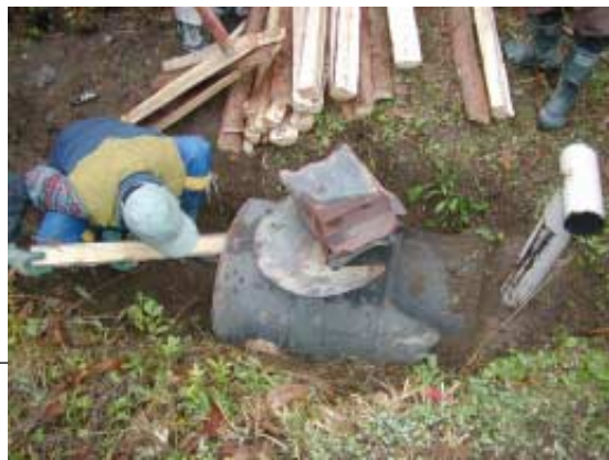
ドラムカン窯に炭材を詰める
