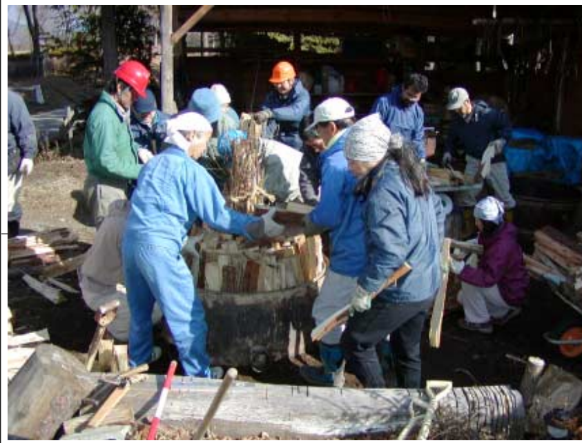
下の口をふさがないように炭材をびっしり詰める
