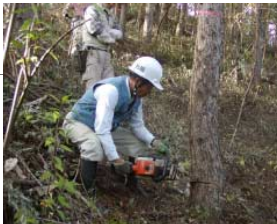
膝に乗せて肘を固定する。チェーンソーのバーがぶれない
