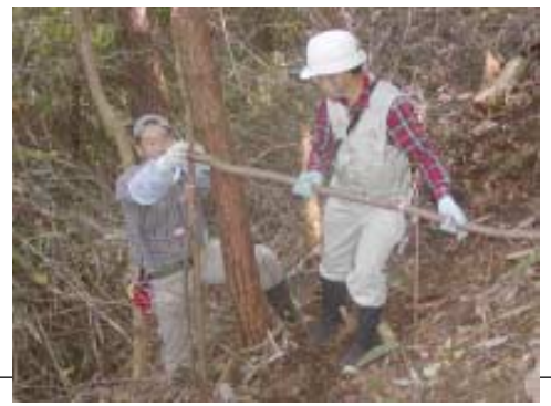
バカ棒で横断測量。ポールの便利さが身にしみる
