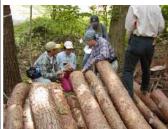
末口は皮なしで最小径を測るのです
