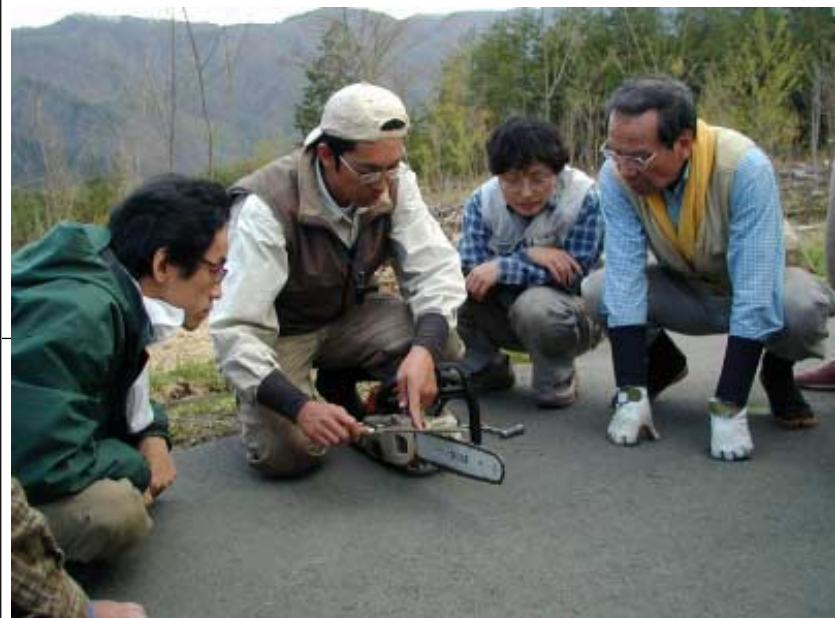
一般的な上刃の目立て角は30°です。ゲージにあわせて
