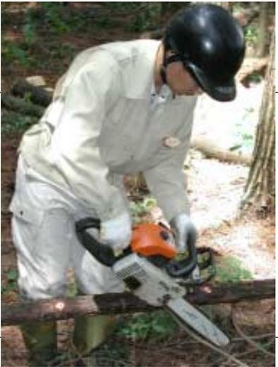
二年目則竹さん、一日の長ありは必ず燃料を抜くこと。抜いた上で始動しキャブレター内の燃料も燃やしてください。燃料が変性しキャブの中に詰まるのを防ぎます。しばらく使っていないチェーンソーがかからない大きな原因
