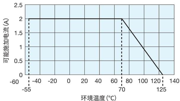
在环境温度70°C以上使用时，应按照上图功率降额曲线，减小施加电流。
